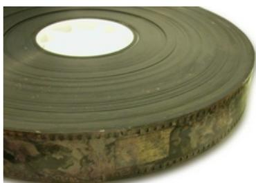
◀バクテリアの被害を受けたフィルム
